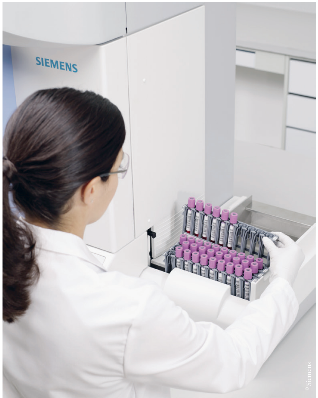
Blut als Beweis: Siemens-Forscher entwickeln einen routinemässigen Malariatest. Damit lassen sich 120 Blutproben pro Stunde automatisch analysieren
