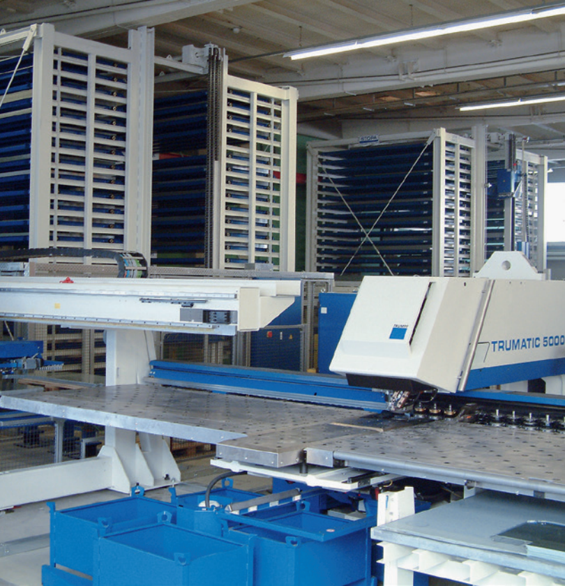
Höchste Präzision: das hochtechnologisierte Stanzzentrum «Trumatic» und die Ein-Arm-Roboter «Bärbel» und «Arnold» leisten Massarbeit.
