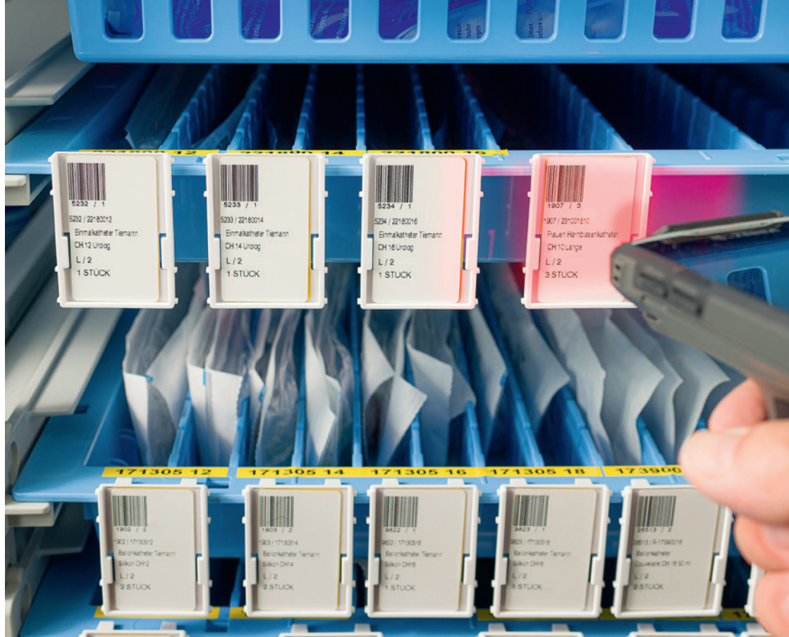
Abbildung 4: Kanban-System: Barcode-scannen bei der Bestellaufnahme
