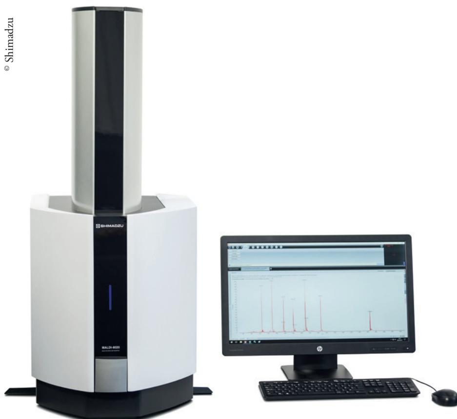
Ce système est idéal pour le développement des méthodes de diagnostic basées sur le MALDI et généralement pour le contrôle qualité des produits pharmaceutiques; il est idéal également pour les laboratoires de recherche et les laboratoires sous contrat dans le domaine des sciences et de l'industrie: spectromètres de masse Benchtop utilisés en mode linéaire dans un d'espace limité avec de nombreuses fonctions intelligentes.
