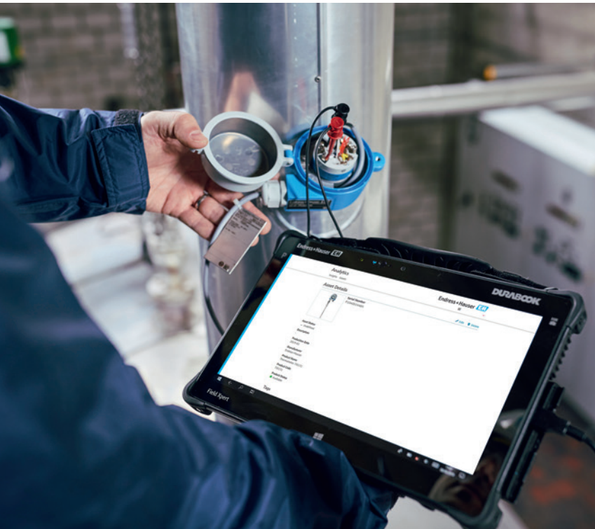
La tablette PC: modèle spécial y compris pour les zones dangereuses telles que Ex-Zone 2 (Field Expert, Endress+Hauser, Reinach). Elle est adaptée au contrôle des instruments de terrain tout au long de leur cycle de vie.
