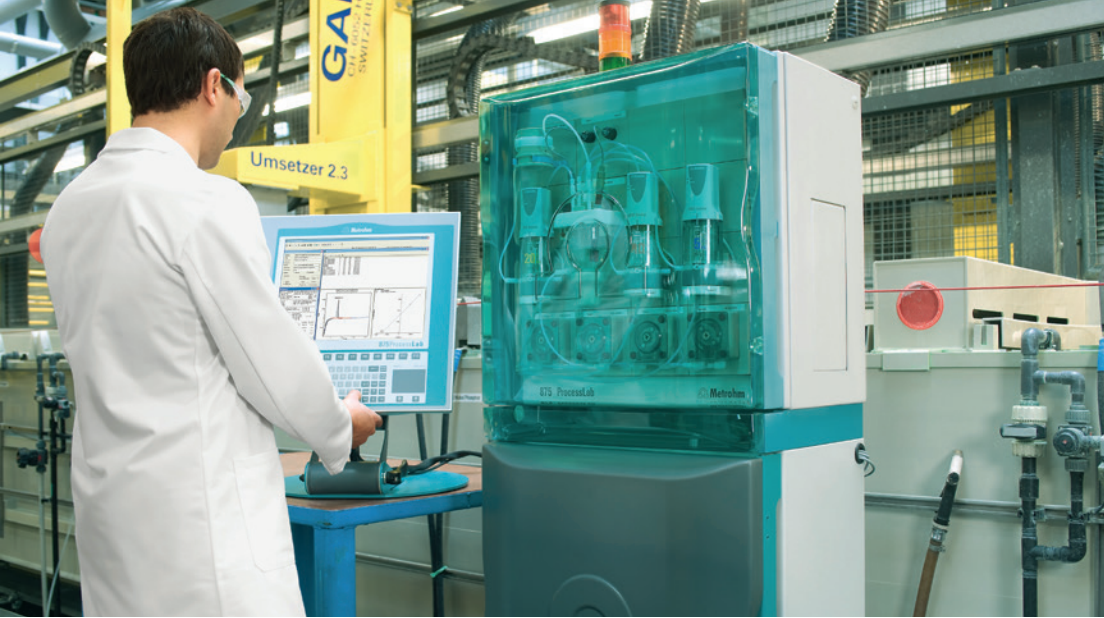
Analyseur de processus entièrement automatisé sur place: Dans l'environnement de processus, l'employé reçoit une assistance complète. (Photo: Metrohm)
