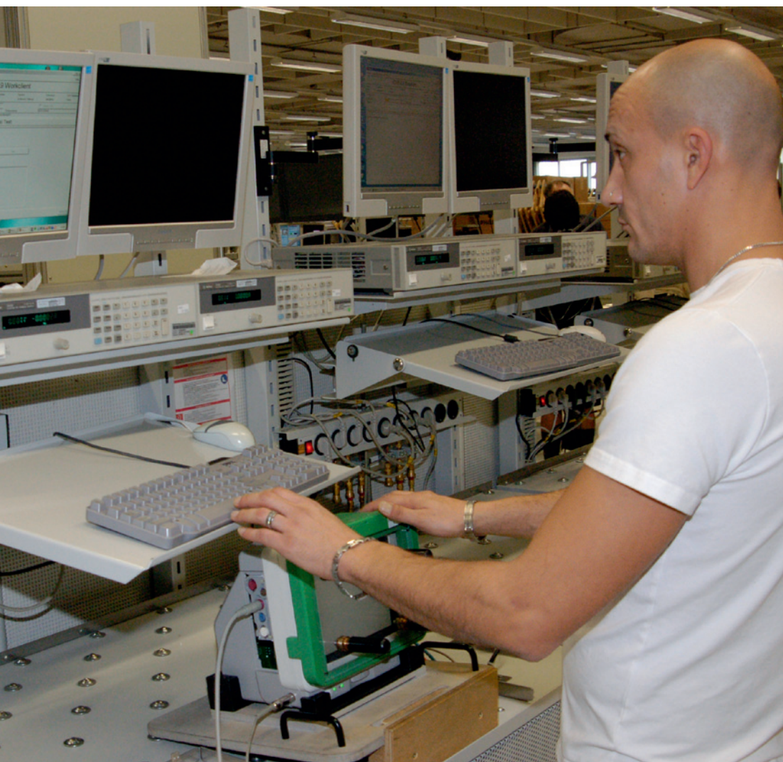
Endtest eines Patientenüberwachungsmonitors vor der Auslieferung
