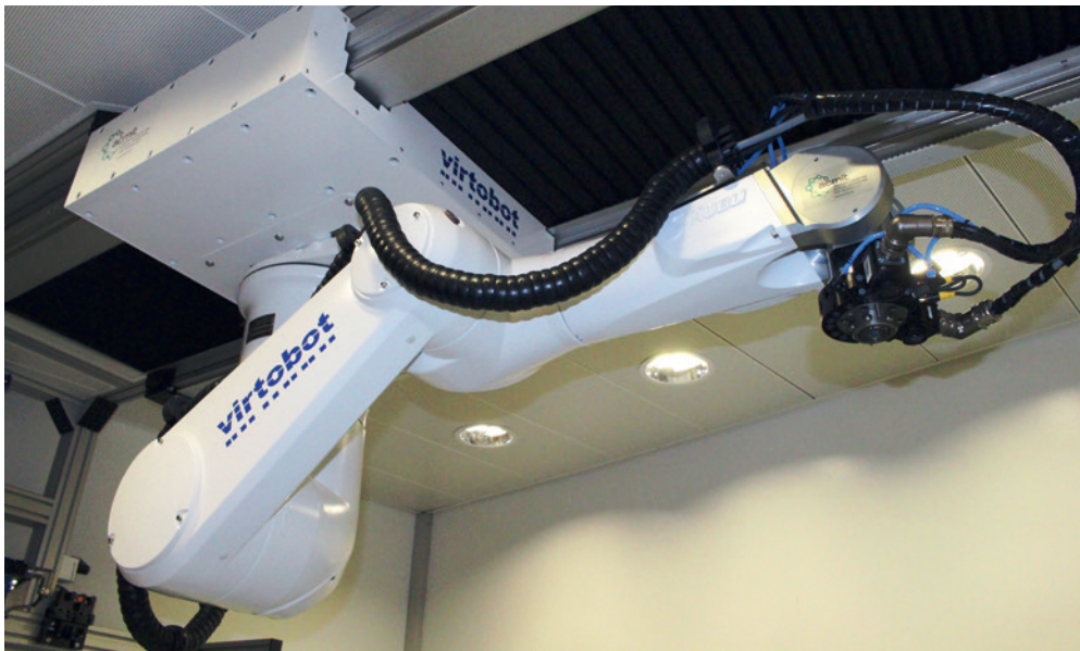
Der Virtobot ist ein automatisiertes System, welches 3D-Oberflächenscanning, CT sowie Biopsie in einem Workflow zusammenfasst.
