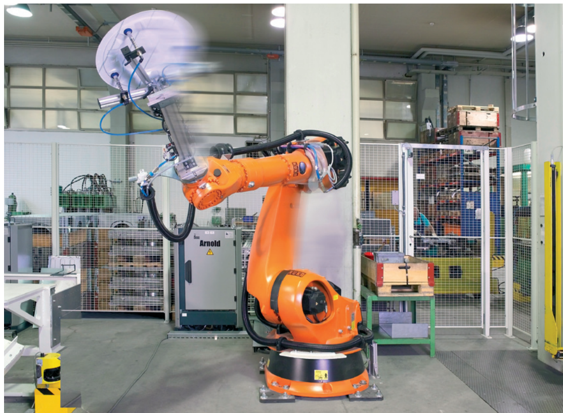
Rationelle Fertigung in Wolfhausen; Roboter «Arnold» in voller Aktion nach Stanzvorgang von Laugenbehälterteil.
