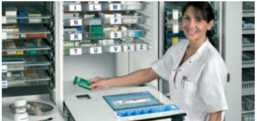
Elektronische Richtstation mit 2-D Barcodeleser, eingebaut in einen Stationszimmerschrank.
