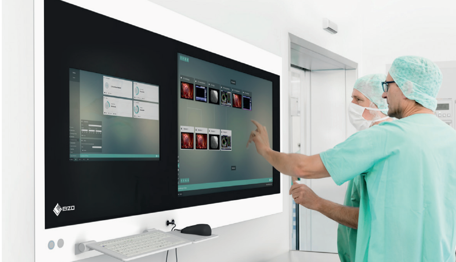
Das Surgical Panel SP2-24-49 mit zwei integrierten Monitoren ist als digitales Bildbetrachtungssystem für den Einsatz im Operationssaal konzipiert.
