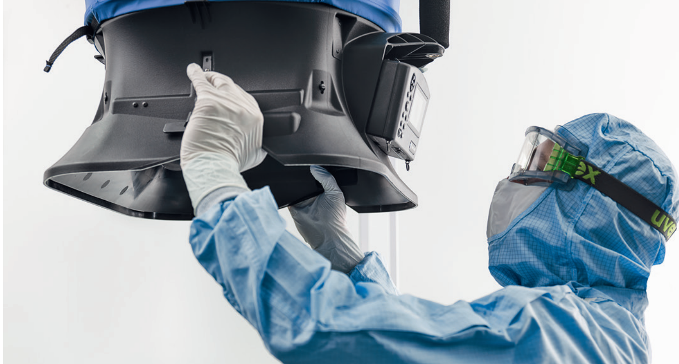
Bild 2: Messung von Luftgeschwindigkeit und Luftvolumenstrom
