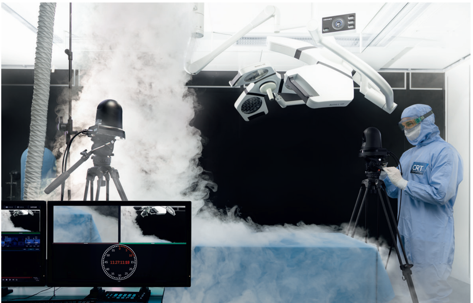
Bild 1: Strömungsvisualisierung im Operationsraum durch Nebelbeaufschlagung
